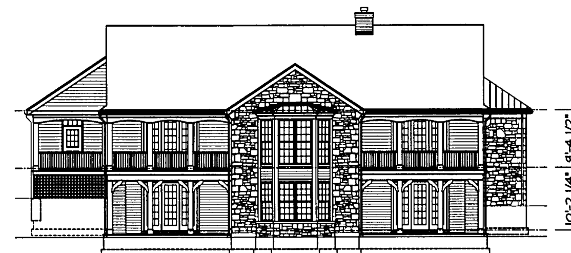
NORTH ELEVATION SCALE: 1/8" = 1'-0"
